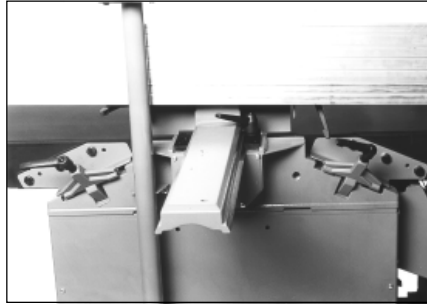
Beide Klemmbriden lösen und zur Seite umklappen.
